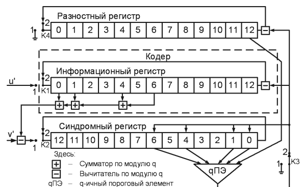
Рис. 9. q МПД блокового СОК с R=1/2 , d=5 и n=26 . Верхние входы ячеек 0, 1, 4 и 6 регистра синдрома вычитаются по модулю q из содержимого соответствующих ячеек
